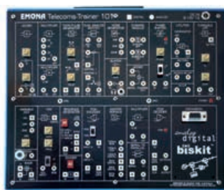
EMONA BISKIT | Kompaktní výukový systém přenosové a laboratorní techniky
