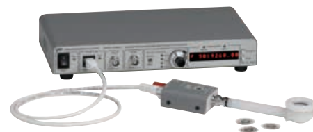
SRS QCM200 | 5 MHz krystalové mikrováčky
